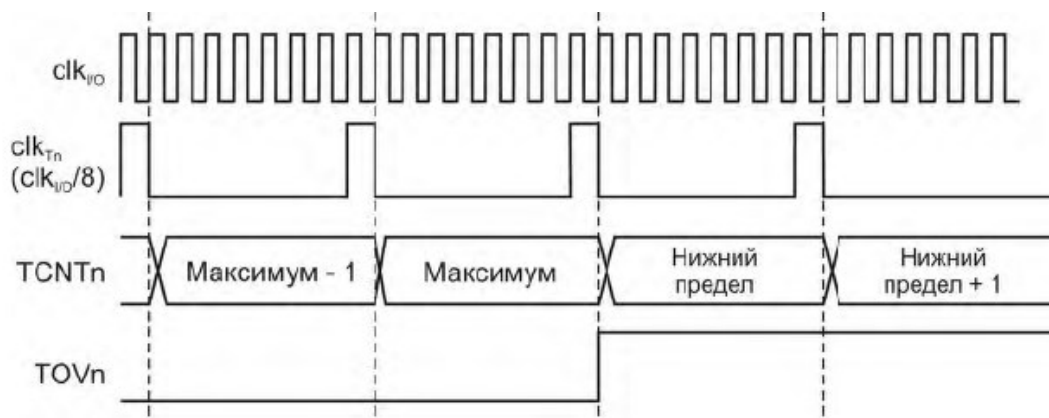
Рис. 9.33. Формирование запроса на прерывание по переполнении счетчика таймера МК 1887BE7T / Atmega128 при прямом счете [8] (коэффициент деления предделителя равен 8-и)
