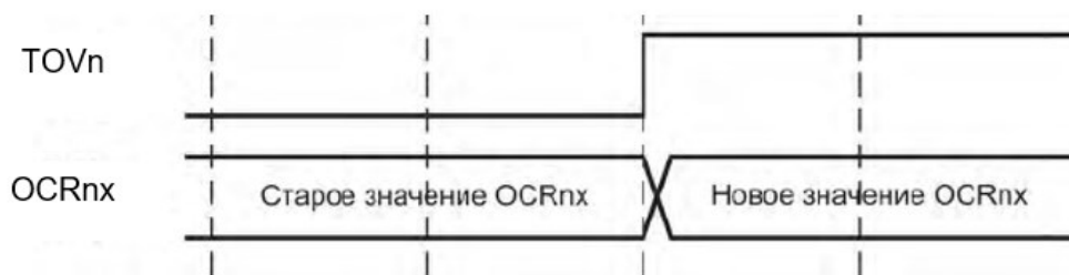
Рис. 9.39. Временные диаграммы перезагрузки регистров сравнения таймеров МК семейства AVR в режиме ШИМ ( n – номер счетчика; x – номер канала; пунктирными линиями обозначено положение во времени активных перепадов счетных импульсов) [8]
