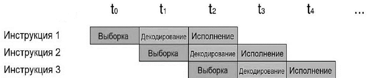
**Рис. 2.45.** Временная диаграмма работы конвейера команд ЦП МК семейства *ARM Cortex-Mx* с коэффициентом совмещения операций, равным 3-м (время указано в тактах ЦП) [9]
